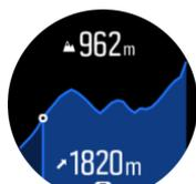
Si te alejas demasiado de la ruta mientras usas la navegación de altitud, tu reloj te avisará con un mensaje **Fuera de ruta** en la pantalla de perfil de altitud. Si ves este mensaje, desplázate hasta la pantalla de navegación de ruta para corregir el rumbo antes de continuar con la navegación de altitud.
