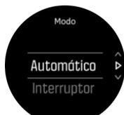
5. Para ajustes con solo dos valores, como p. ej., activado o desactivado, cambia el valor tocando el ajuste o pulsando el botón central.
